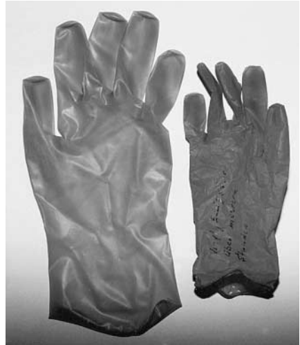
Abb. 14: Degradation, hier Material-schrumpfung eines Vinylhandschuhs nach chemischer Einwirkung von Essigsäuren, Quelle: Bundesverband Handschutz e.V., Frank Zuther
